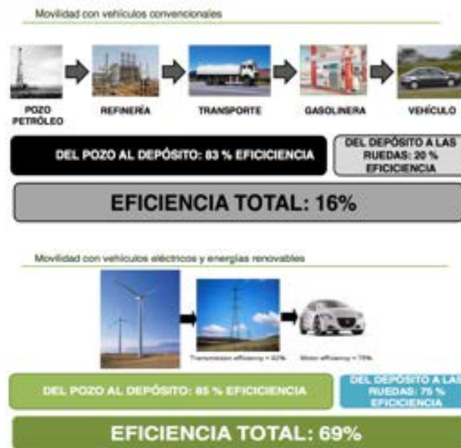
Figura 10.13: Itinerario energético comparado entre hidrocarburos y electricidad.
