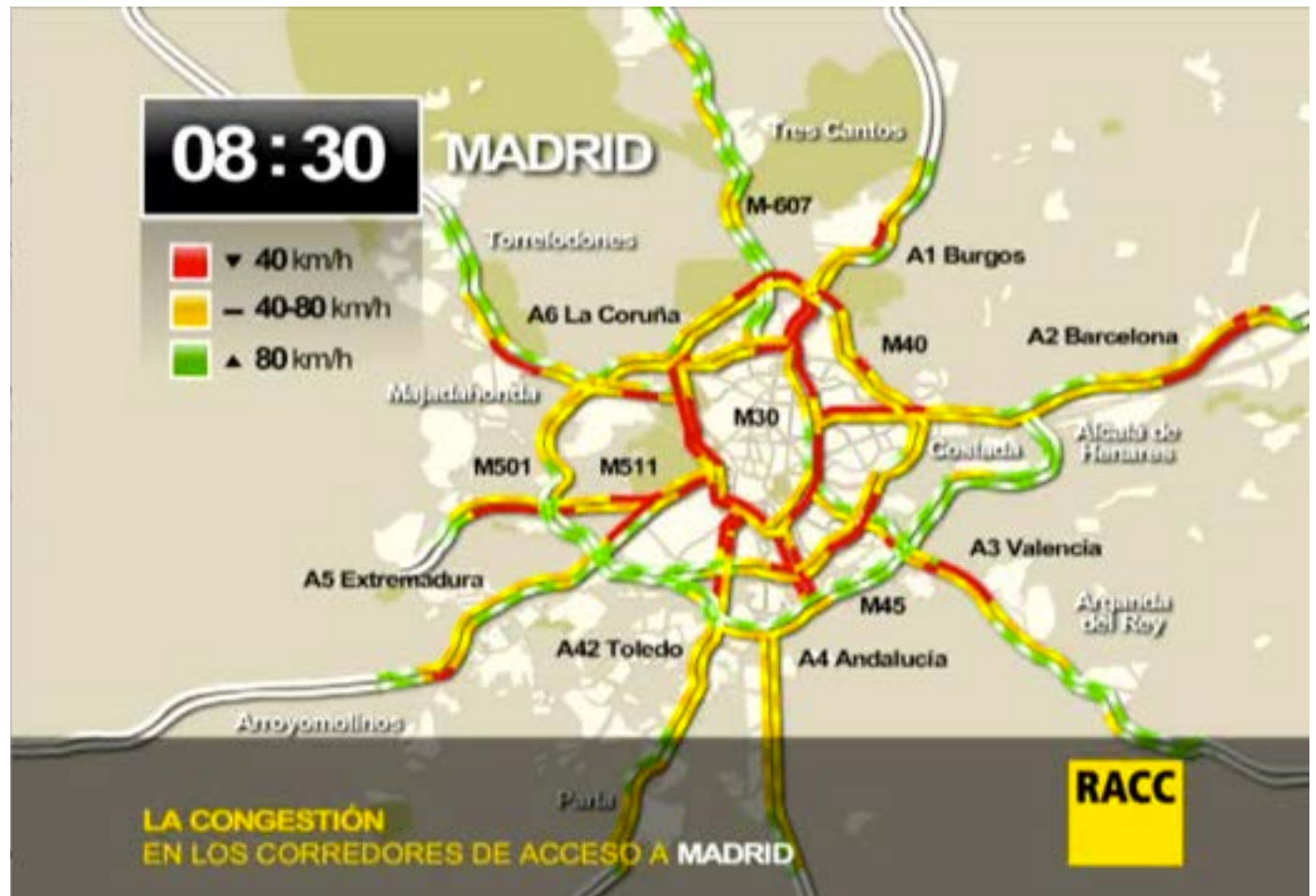
Figura 7.9: Fotograma de video-composición de velocidad media en la red viaria metropolitana de Madrid entre las 8:30 y 8.54. Fuente: Congestión en los corredores viarios de alta capacidad de acceso a Madrid. Fundación RACC. 2009.
