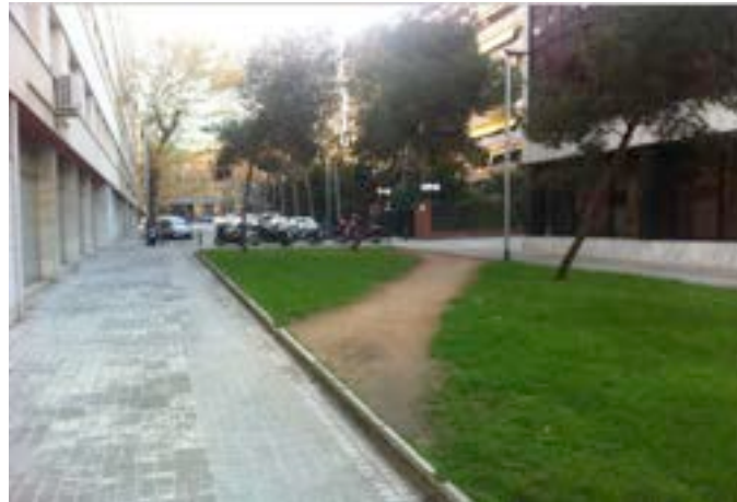
Figura 2.34: Itinerario peatonal interrumpido sin cruce directo.
