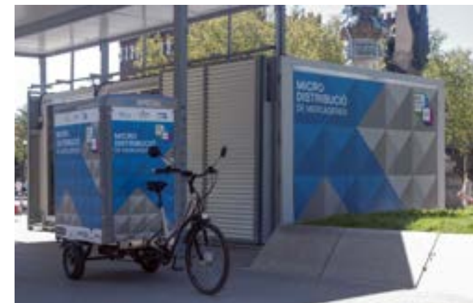
Figura 4.28: Micro-plataforma logística y sistema de distribución mediante bicicletas con motorización eléctrica
