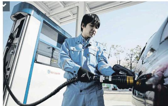
Un operario inyecta hidrógeno a un vehículo Toyota en una estación de servicio adaptada, en Japón
